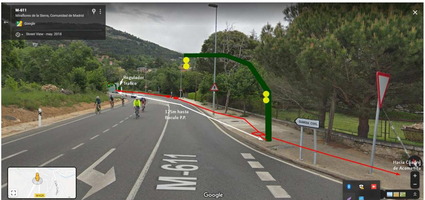
Para la acometida eléctrica se tomará alimentación de un cuadro de alumbrado municipal existente en las inmediaciones del cruce de la calle Abeto y la calle del Océano Pacífico. Se usará la canalización de alumbrado existente hasta el cruce con la M-6111 en donde se conectará con la nueva canalización a realizar.
