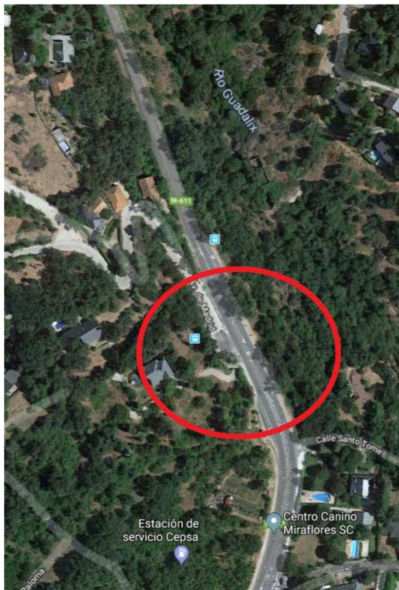
La obra consistirá en la instalación de un paso de peatones regulado por semáforos con pulsador y de dos preavisos a unos 150m del paso para señalar la existencia de dicho paso e indicar que se debe circular con precaución en esa zona.
